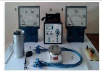
Figura 1. Equivalente mecánico del calor por un método eléctrico.
